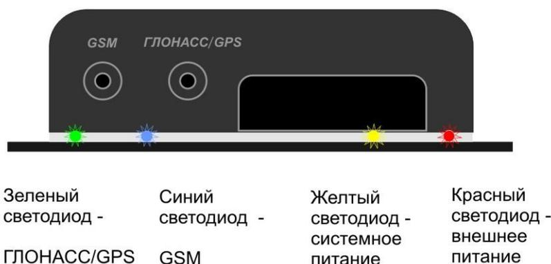
Рис. 3. Светодиодная индикация терминала
