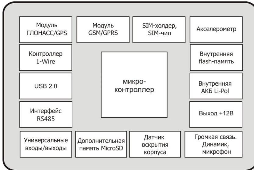
**Модуль ГЛОНАСС/GPS** предназначен для приема сигналов от спутников системы ГЛОНАСС/GPS и определения географических координат местоположения (широты, долготы и высоты), скорости, направления движения, даты и точного времени по Гринвичу.
