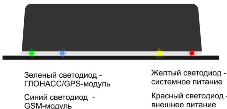
**Зеленый** светодиод отображает состояние модуля ГЛОНАСС/GPS:
