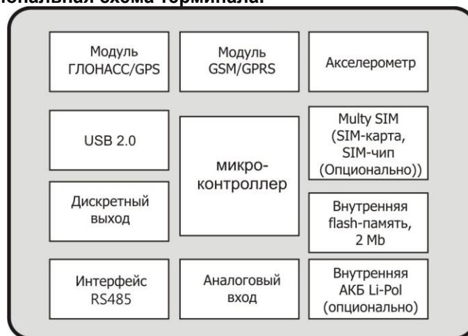
**Модуль ГЛОНАСС/GPS** предназначен для приема сигналов от спутников системы ГЛОНАСС/GPS и определения географических координат местоположения (широты, долготы и высоты), скорости, направления движения, даты и точного времени по Гринвичу.
