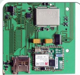
Модуль GPS / Глонасс. Wi-Fi 802.11 b/g/n. Дополнительная память: две micro SD Card объемом до 32Гб.
