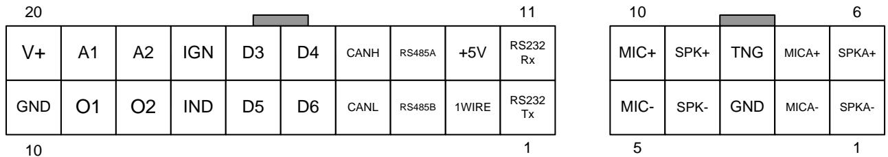
Рисунок 3.2. Интерфейсные разъемы терминала FORT-112-3G
